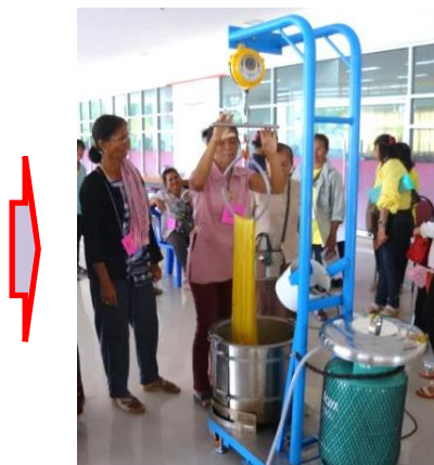
ก) อุปกรณ์ย้อมสีเส้นไหมแบบเดิม ข) เครื่องจักรสำหรับการย้อมสีเส้นไหม
