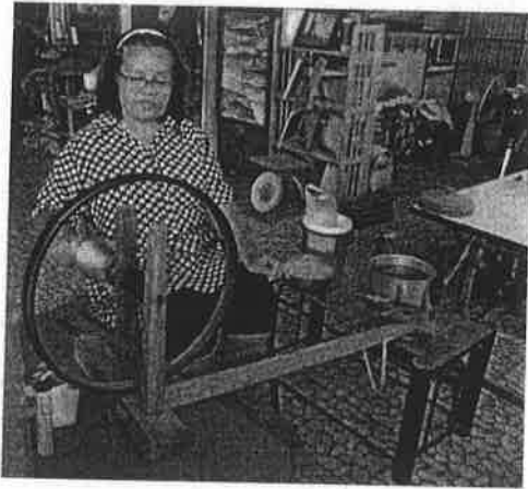
ก) อุปกรณ์ตีเกลียวเส้นไหมแบบเดิม
