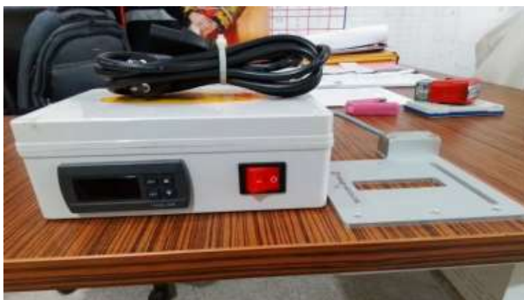
เครื่องอุ่นแผ่นสไลด์บนกล้องจุลทรรศน์ (สแตตวอร์มเมอร์) ๑ เครื่อง
